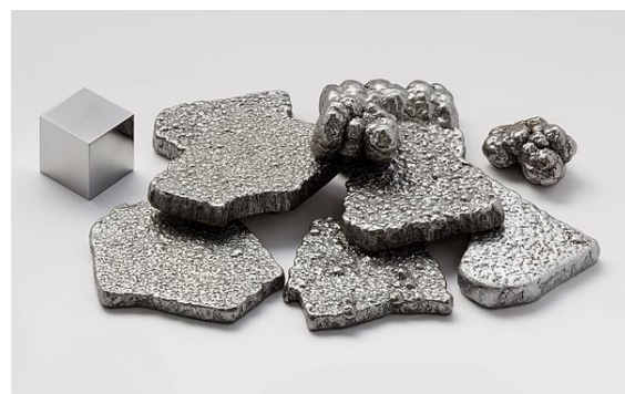
hochreines (99,97 %+) elektrolytisch hergestelltes Eisen
